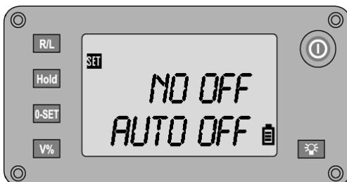
Включение/выключение функции автоматического отключения прибора
