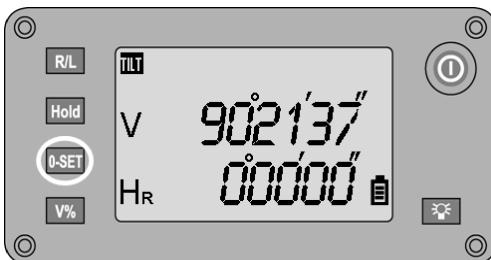
Odczyt wskazania koła poziomego można w dowolnej chwili wyzerować naciskając przycisk **0-SET**, wyznaczając tym samym punkt odniesienia lub punkt zerowy koła poziomego.
