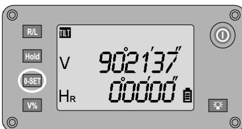
Отсчёт по горизонтальному кругу может быть обнулён в любое время путём нажатия кнопки **0-SET** и тем самым установки опорной или нулевой точки для горизонтального круга.
