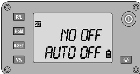
Aktivering og deaktivering af instrumentets automatiske slukning
