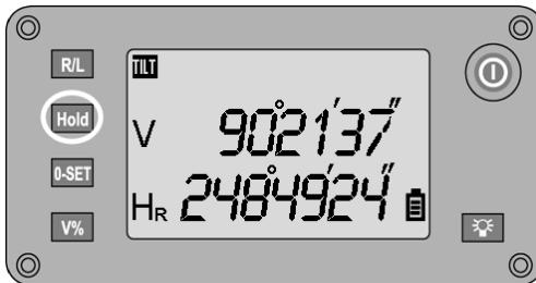
Отсчёт по горизонтальному кругу может быть приостановлен путём нажатия кнопки **HOLD**; затем визируется новая цель и посредством повторного нажатия кнопки отсчёт по кругу может быть возобновлён.
