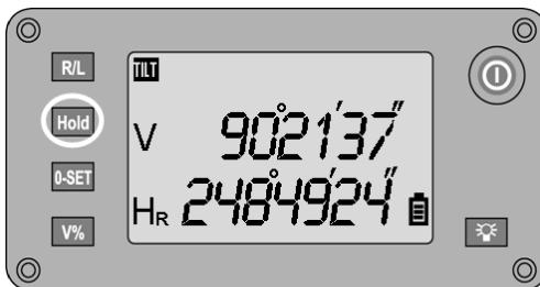
Odečítání hodnot na vodorovném kruhu lze stisknutím tlačítka **HOLD** přidržet, poté zaměřit nový cíl a opětovným stisknutím tlačítka odečítání hodnot znova uvolnit.
