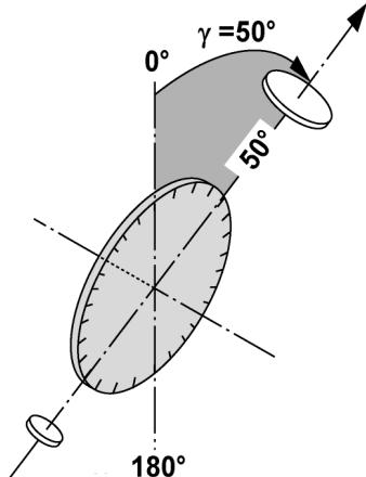
Tím, že svislý kruh lze vyrovnat na  $0^\circ$  ke směru gravitace nebo  $0^\circ$  k vodorovnému směru, jsou zde úhly v podstatě určeny směrem gravitace.
