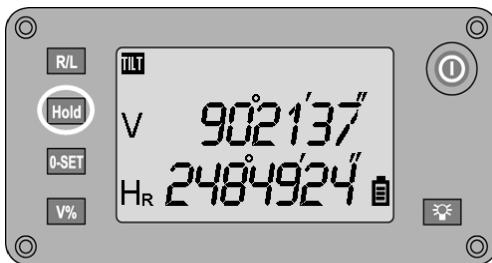
Vaakakehäluke voidaan painiketta **HOLD** painamalla asettaa pitoon, minkä jälkeen voidaan tähdätä uuteen kohteeseen ja painiketta uudelleen painamalla vapauttaa kehälukema.
