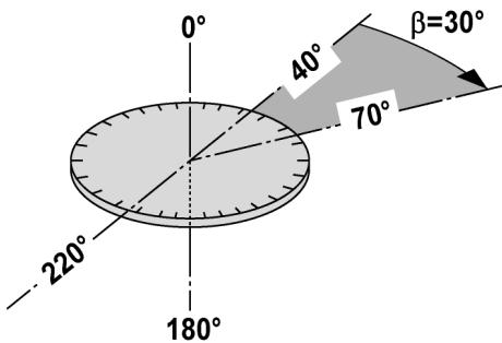
Z naměřených hodnot odečtených na vodorovném kruhu  $70^\circ$  k jednomu cíli a  $40^\circ$  k druhému cíli lze vypočítat svíraný úhel  $70^\circ - 40^\circ = 30^\circ$ .
