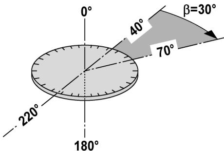
На основании измерений по горизонтальному кругу ( $70^\circ$  относительно одной цели и  $40^\circ$  относительно другой) можно рассчитать промежуточный угол:  $70^\circ - 40^\circ = 30^\circ$ .
