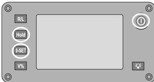
Drücken Sie die Taste **Hold** und die Taste **0-Set** gleichzeitig und halten Sie diese gedrückt.
