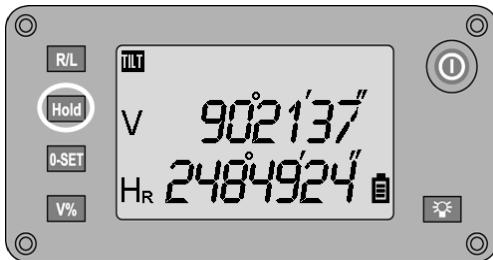
Horisontalkredsaflæsningen kan fastholdes ved at trykke på tasten **HOLD**, og fjernes igen ved at sigte mod et nyt mål og trykke på tasten igen.
