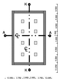
Augstuma atzīmes būvobjekta teritorijā un ap to, kā arī būvkonstrukciju asis parasti pirms būvdarbu uzsākšanas uzmēra un atzīmē mērniecības uzņēmums.
