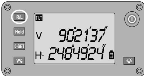
A direcção para a medição de ângulos horizontais pode ser alterada entre Direita – no sentido dos ponteiros do relógio e Esquerda – no sentido contrário aos ponteiros do relógio premindo a tecla **R/L**.
