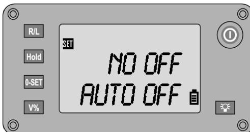
Strömbrytare för automatisk fränkoppling av instrumentet
