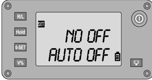
Inn- og utkobling av automatisk utkobling av apparatet
