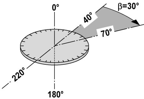
Fra de målte horisontale kredsaflæsninger med 70° til ét mål og 40° til et andet mål kan den inkluderede vinkel  $70^\circ - 40^\circ = 30^\circ$  beregnes.
