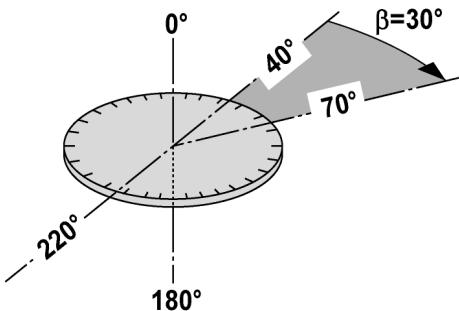
Von den gemessenen horizontalen Kreisablesungen mit 70° zum einen Ziel und 40° zum anderen Ziel kann der eingeschlossene Winkel  $70^\circ - 40^\circ = 30^\circ$  berechnet werden.
