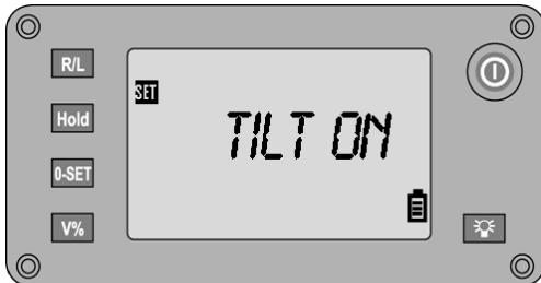
Zapnutí, resp. vypnutí kompenzátoru
