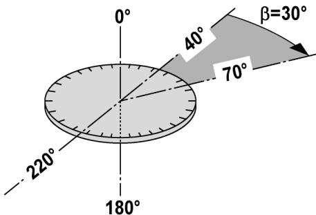
Av de uppmätta avläsningarna av horisontalringen med  $70^\circ$  till det ena målet och  $40^\circ$  till det andra kan den inneslutna vinkeln beräknas till  $70^\circ - 40^\circ = 30^\circ$ .
