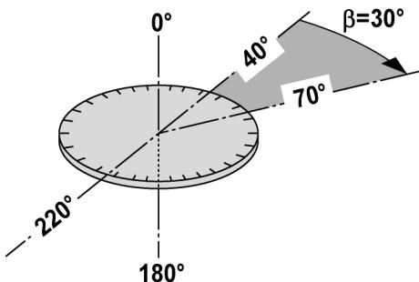
Van de gemeten horizontale cirkelaflezingen met  $70^\circ$  ten opzichte van een punt en  $40^\circ$  t.o.v. een ander punt kan de ingesloten hoek  $70^\circ - 40^\circ = 30^\circ$  worden berekend.
