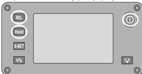
1. Držte stisknuté tlačítko **R/L** a tlačítko **Hold** a poté stiskněte tlačítko **ZAP/VYP**.
