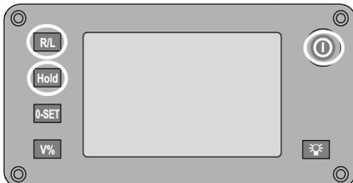
1. Hold **R/L**-tasten og **Hold**-tasten inne og trykk så på **på/av**-tasten.
