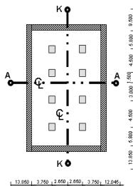
Przed rozpoczęciem budowy firma zajmująca się pomiarami wyznacza na placu budowy i wokół niego znaczniki wysokości i osie budowli.
