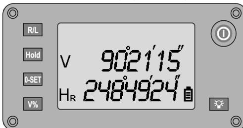
7. Tryk på tasten **0SET** for at foretage en vinkelmåling i position 2.
