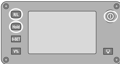
1. Mantenga pulsadas las teclas **R/L** y **Hold** y pulsar seguidamente la tecla de **encendido/apagado**.
