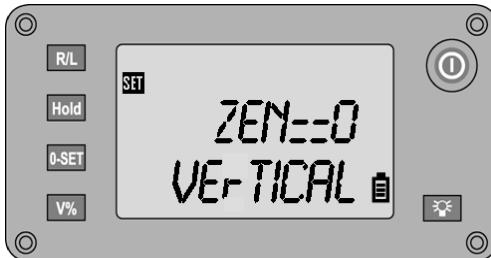
Ajuste del cenit o de la posición de referencia para las lecturas del círculo vertical
