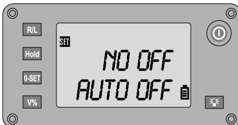
Activation resp. désactivation de l'arrêt automatique de l'appareil
