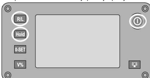
1. Držte stlačené tlačidlo **R/L** a tlačidlo **Hold** a potom stlačte tlačidlo **ZAP/VYP**.
