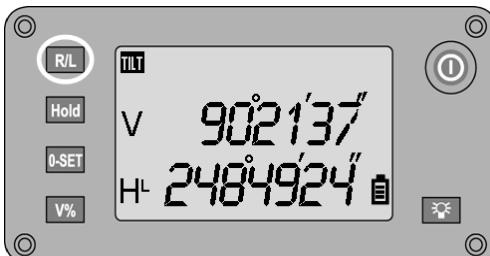
Směr měření lze při měření vodorovných úhlů stisknutím tlačítka **R/L** přepínat mezi vpravo (ve směru hodinových ručiček) a vlevo (proti směru hodinových ručiček).
