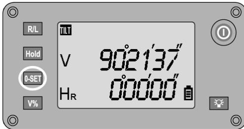
A leitura do limbo horizontal pode ser colocada a zero em qualquer altura premindo a tecla **0-SET** e, deste modo, definido o ponto de referência ou zero para o limbo horizontal.
