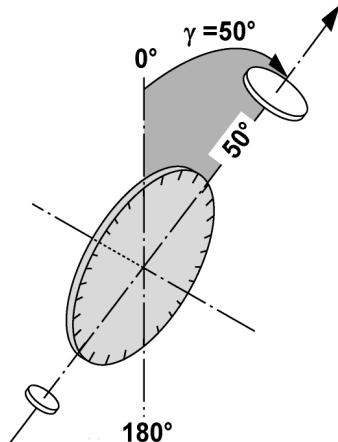
Ved at vertikalsirkelen kan innrettes med  $0^\circ$  på gravitasjonsretningen eller med  $0^\circ$  på horisontalretningen, bestemmes tenkte vinkler fra gravitasjonsretningen.
