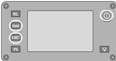
Appuyer simultanément sur les touches **Hold** et **0-Set**, et les maintenir enfoncées.
