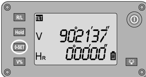
La lectura del círculo horizontal puede ajustarse a cero en cualquier momento pulsando la tecla **0- SET** y, de esta forma, ajustar el punto de referencia o punto cero para el círculo horizontal.
