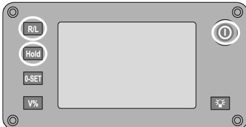
1. Hold tasten **R/L** og tasten **Hold** nede, og tryk derefter på tasten **TIL/FRA**.
