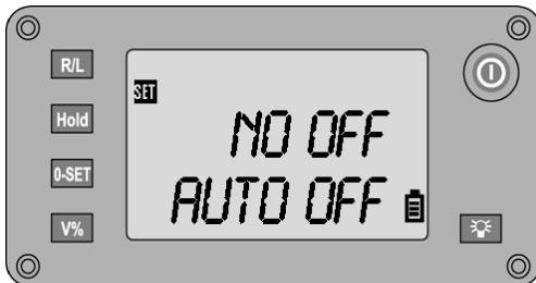
Zapnutie, resp. vypnutie automatického vypínania prístroja
