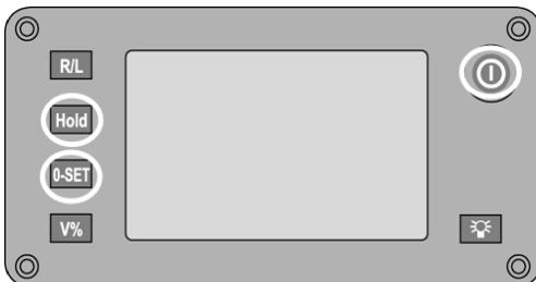
Prima simultaneamente as teclas **HOLD** e **0-SET** e mantenha-as premidas.
