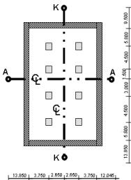
Em geral, uma empresa de topografia marca primeiros pontos de referência e eixos de construção dentro e à volta da área de construção, antes do início da obra.
