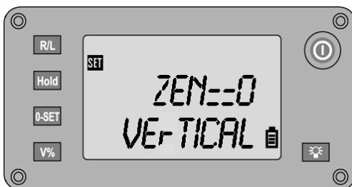
Innstilling av Zenit, dvs. referanseposisjon for vertikalavlesninger
