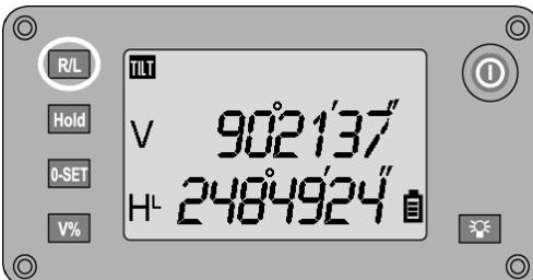
Måleretningen for den horizontale vinkelmåling kan ændres mellem højre (R) – med uret og venstre (L) – mod uret ved at trykke på **tasten R/L**.
