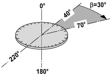
El ángulo encerrado de  $70^\circ - 40^\circ = 30^\circ$  puede calcularse a partir de las lecturas del círculo horizontal medidas con un ángulo de  $70^\circ$  con respecto al objetivo y un ángulo de  $40^\circ$  con respecto al otro objetivo.
