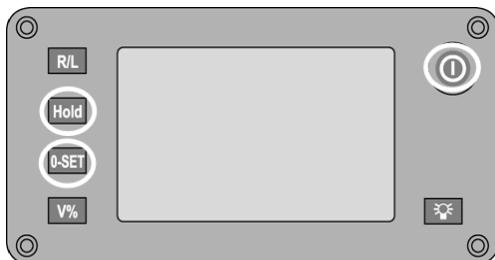
Pulse simultáneamente la tecla **Hold** y la tecla **0-Set** y manténgalas pulsadas.
