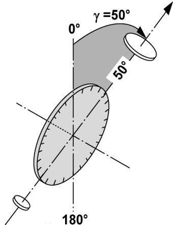
Devido ao facto de o limbo vertical poder ser alinhado em  $0^\circ$  com a direcção da gravidade ou a direcção horizontal, os ângulos são nesta situação virtualmente determinados pela direcção da gravidade.
