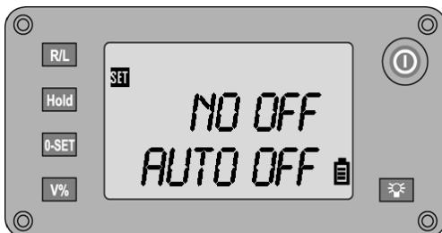
In- resp. uitschakelen van de automatische uitschakeling van het apparaat
