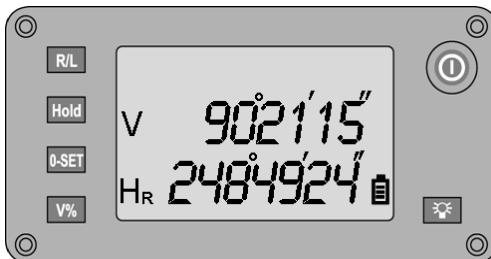
7. Nacisnąć przycisk **0-SET**, aby wykonać pomiar kąta w położeniu 2.
