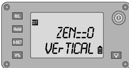
Indstilling af zenith og referencepositionen for vertikalkredsafslæsninger
