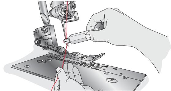
Ziehen Sie die Fadenschlinge mithilfe des Nadeleinfädlers hinten an der Nadel heraus.
