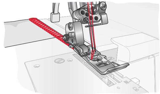
*Tipp: Wenn die Maschine neu eingefädelt ist, sollten Sie die Fadenspannung immer durch Abketteln und Nähen eines Teststreifens prüfen.*
