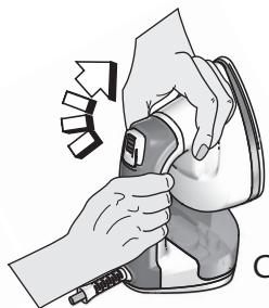
C Ruotare la piastra in senso orario utilizzando l'apposita impugnatura
