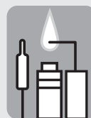
Abb. 4a: Wächterflamme brennt falsch
